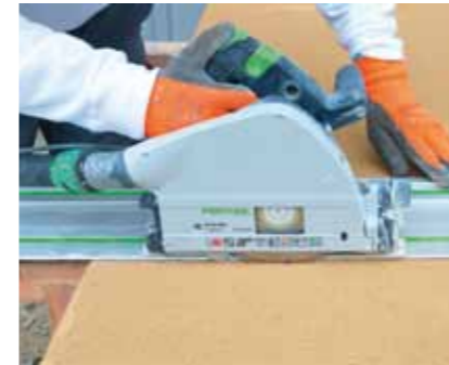
Einfache, saubere Plattenschnitte mit der Handkreissäge
